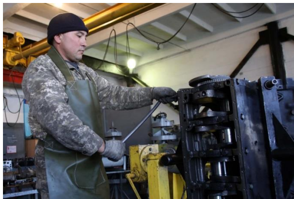
Рис. 2 Проведение ремонта двигателя в мастерской. (город Алматы, воинская часть 7552)
