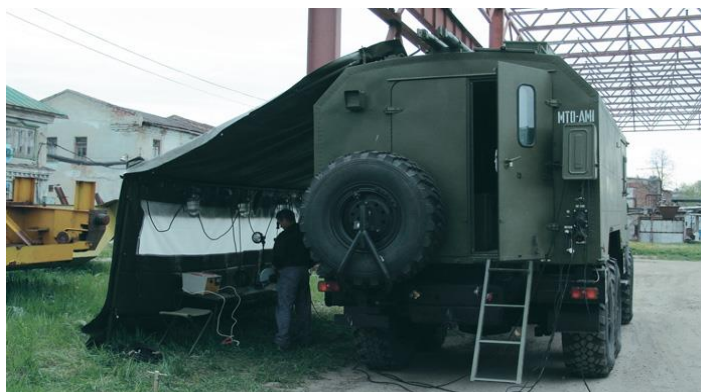
Рис. 3 Унифицированная подвижная мастерская технического обслуживания и текущего ремонта автомобилей МТО-АТ. (город Алматы, воинская часть 5572)
