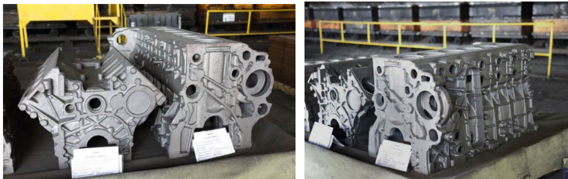
Рисунок 1 Слева — блок цилиндров камазовского V8, справа — рядного 6-цилиндрового дизеля нового поколения
